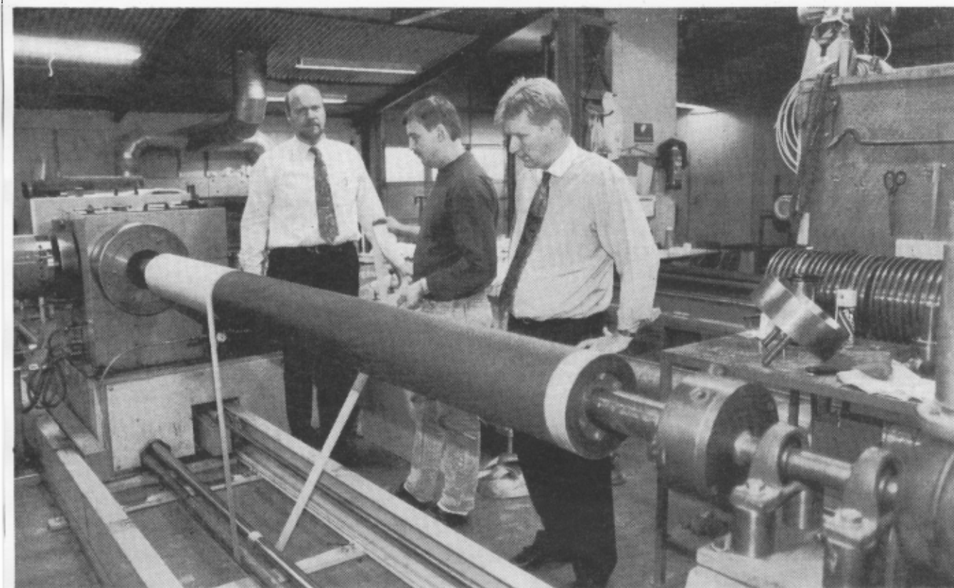
Et kig ind i den jubilerende virksomhed på Norgesvej, Teknisk Gummi Horsens A/S, der er den største gummivalsefabrik i Danmark og råder over et veludviklet og patenteret produktionsudstyr, bl.a. denne krydshoved-ekstruder, som firmaet selv har udviklet. Fra venstre er det adm. direktør Carsten Bo Petersen, specialarbejder Flemming Olesen og fabrikant, arbejdende bestyrelsesformand og eneaktionær Klaus Rasmussen.
